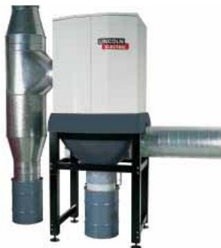
Для централизованной системы вытяжки рекомендуется Statiflex 6000-MS. Это низковакуумное устройство обеспечивает производительность 6375 м<sup>3</sup>/час, что позволяет обслуживать до четырех сварочных постов одновременно.
