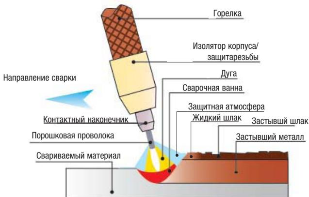
Сварка проволокой Innershield происходит без применения защитного газа. Innershield является самозащитной порошковой проволокой (метод FCAW-SS). Флюсы, находящиеся в сердечнике проволоки, во время сварки выделяют газы и шлак, защищающие ванну и горячий затвердевший металл шва.
