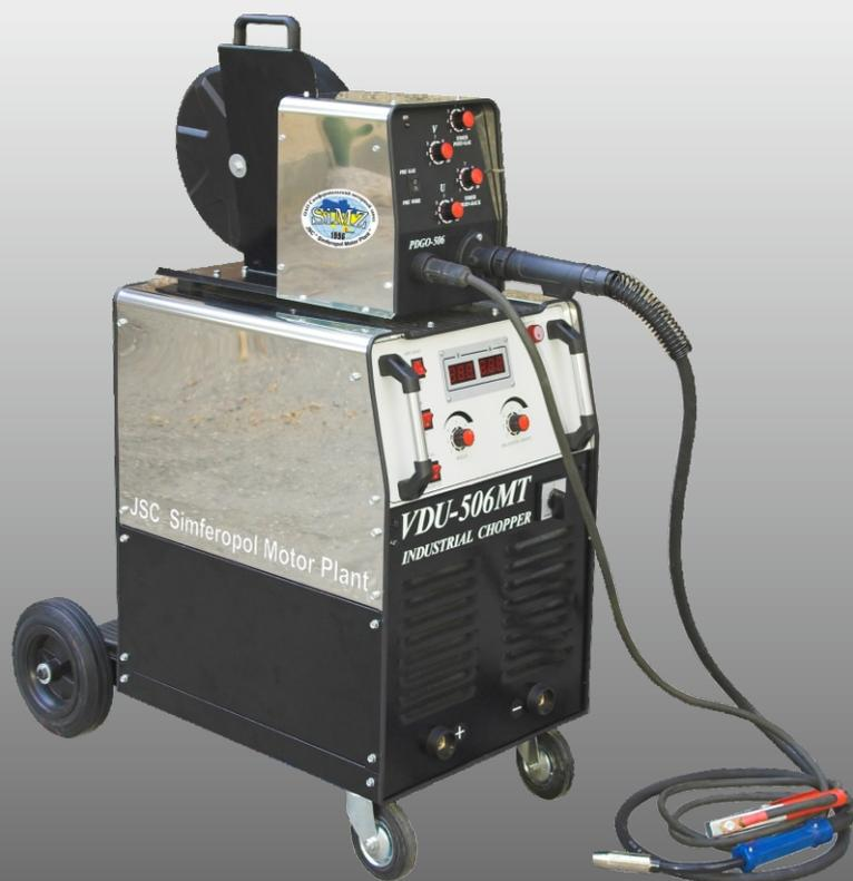
**RUS** Чопперы — это продукт соединения преимуществ традиционного и инверторного оборудования — одно из современных направлений в развитии сварочной техники на базе высокочастотных преобразователей.
