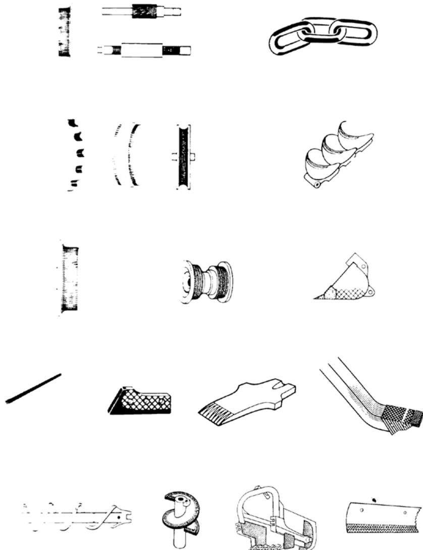
Примеры применения для наплавки.
